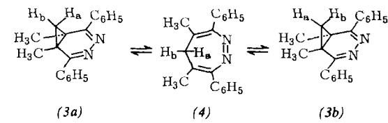
Die beiden geminalen Cyclopropan-Protonen  $\text{H}_a$  und  $\text{H}_b$  geben bei Raumtemperatur zwei Doublets. Die Aufspaltung geht beim Erwärmen auf 70 °C verloren, bei 130 °C erscheint
